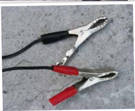
■ Les pinces crocodiles du même modèle. Légères et mal adaptées, il a d'abord fallu en ressortir une pour pouvoir s'en servir. Les isolants sont de simples gaines de caoutchouc.
