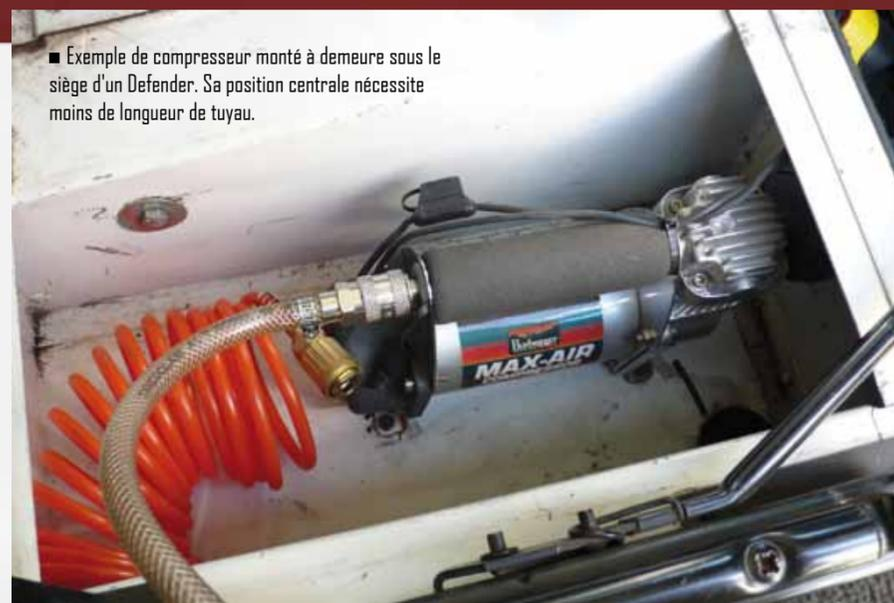
■ Exemple de compresseur monté à demeure sous le siège d'un Defender. Sa position centrale nécessite moins de longueur de tuyau.
