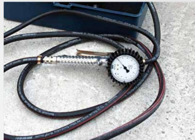
■ Le manomètre et le tuyau du 327 sont d'une telle qualité de précision et de robustesse qu'on peut les utiliser sans problème pour un usage continu quasi professionnel. Rappelons au passage que ce type de manomètre sert aussi bien à gonfler qu'à dégonfler...
